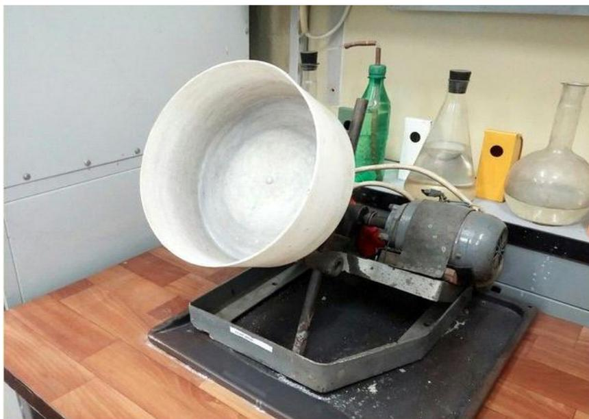
Рисунок А.2 – Лабораторный тарельчатый гранулятор
